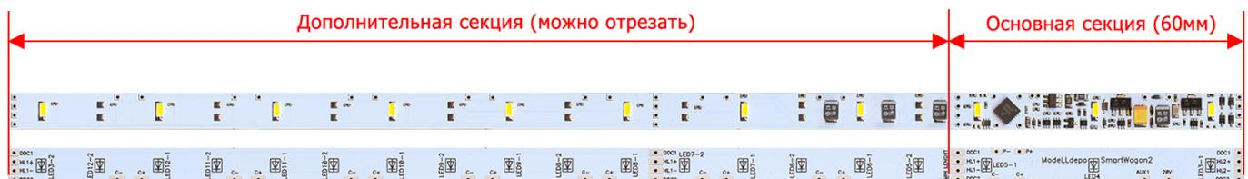
Декодер необходимо подключить к токосъему, для этого потребуется 2 провода, можно использовать как собственный токосъем вагона, так и токосъем локомотива, в последнем случае придется тянуть провода в локомотив через сцепку.
